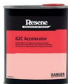
62C Accelerator es un aditivo para los productos Durepox. La adición de un 5% en volumen de 62C Accelerator reducirá a aproximadamente la mitad el tiempo de curado y la vida de la mezcla.
